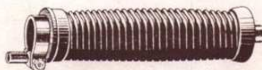
Manchon extérieur avec caoutchouc et dispositif de freinage
